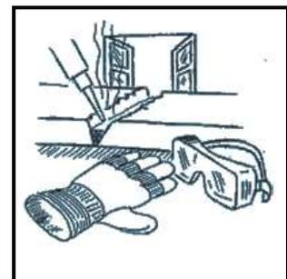
4) Après 30 minutes de pause, lorsque le cordon de colle est solidifié, il peut être usiné, meulé, percé. Une peinture peut être appliquée pour uniformiser la teinte du produit de base et du joint de collage.
